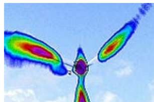
Blau gleich leise und Rot gleich laut: Schallbild eines Windrads
